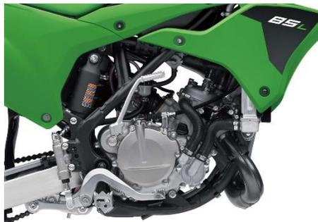
Mesin 84 cc berperforma tinggi menghasilkan tenaga yang tajam dan responsif serta menawarkan ketahanan yang telah terbukti untuk menyelesaikan setiap perjalanan dengan percaya diri. Transmisi enam kecepatan rasio dekat dan kopling manual memungkinkan calon pembalap mengasah keterampilan perpindahan gigi dan mendapatkan performa maksimal dari KX85.
