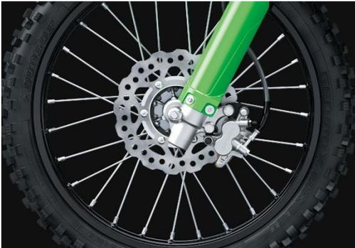
*Disc brake petal*  $\varnothing 220$  mm di depan dan *disc brake petal*  $\varnothing 184$  mm di belakang menawarkan kinerja pengereman progresif untuk pengendara yang percaya diri. Desain petal atau kelopak mengurangi berat unsprung sekaligus membantu menjaga bantalan rem tetap bersih dan dingin. Hasilnya adalah performa pengereman yang konsisten dengan rasa yang baik.
